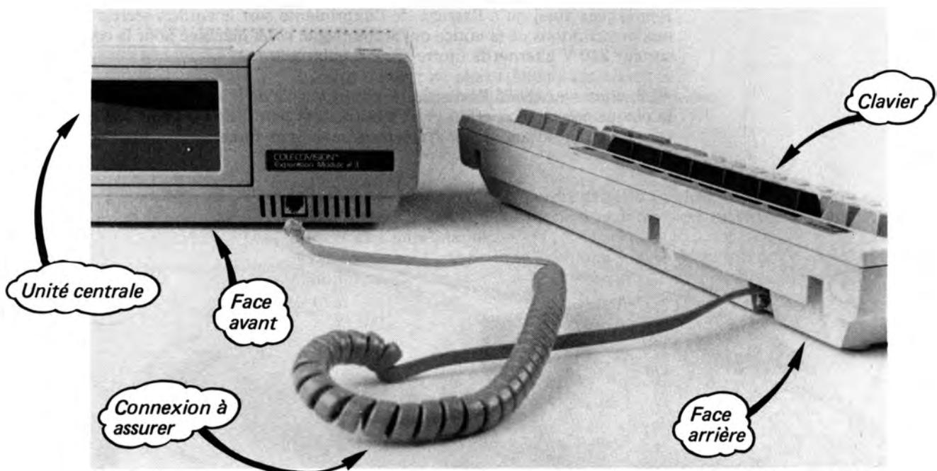
Enfichez simplement le câble extensible d'un côté, à l'arrière du clavier, de l'autre, sur l'avant de l'unité centrale.
